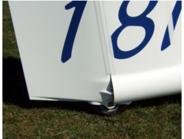
Das lenkbare Spornrad hilft sehr beim Ausrollen, erfordert aber ruhige Füße beim Anrollen zum Start.
