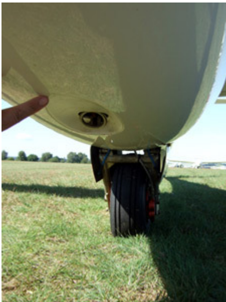
Die Kupplung befindet sich etwa 50cm vor dem großen Fahrwerk und dient für F-Schlepp und Windenstarts.
