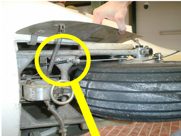
Abbildung 2: Übersicht zur Verlegung des Seilzuges
