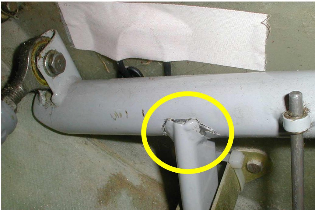
Abbildung 4: Schaden von hinten
